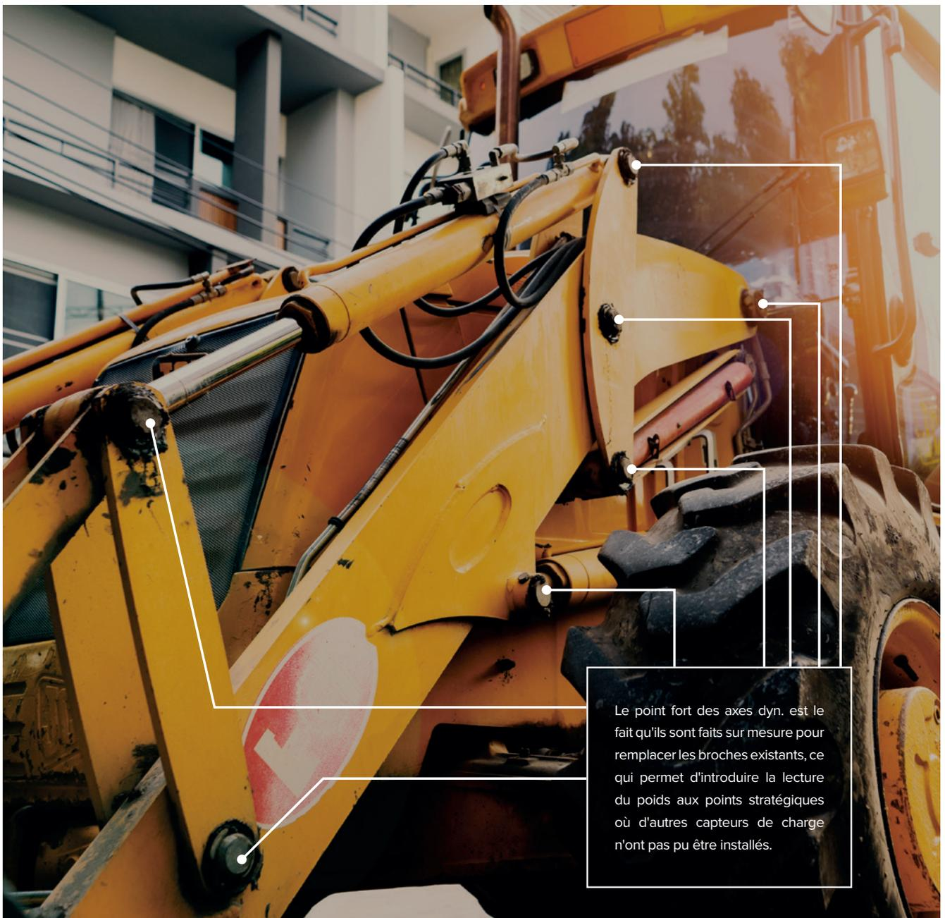
Le point fort des axes dyn. est le fait qu'ils sont faits sur mesure pour remplacer les broches existants, ce qui permet d'introduire la lecture du poids aux points stratégiques où d'autres capteurs de charge n'ont pas pu être installés.
